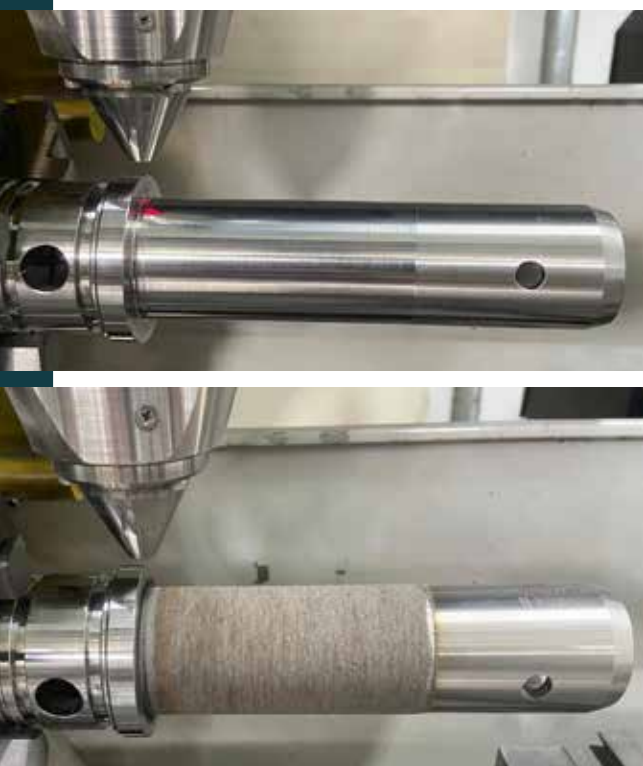
Antes e depois: deposição de materiais a laser é cem vezes mais rápida e oferece melhor aproveitamento de materiais para recuperar componentes industriais
